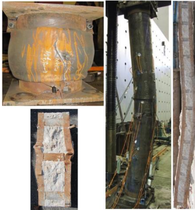
内配钢筋钢管混凝土构件试验
