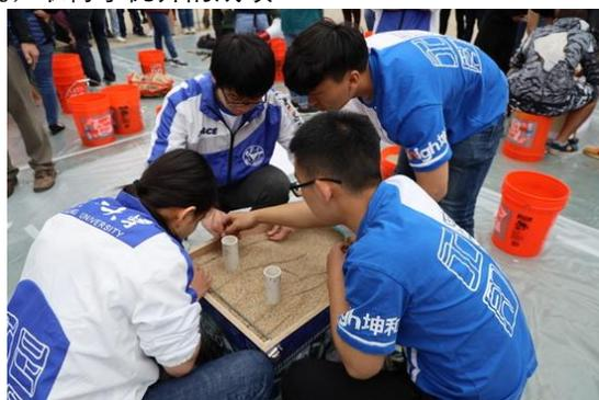
在近六个月的备赛中，挡土墙组进行了百余次实验，并结合理论和实验结果，创新地采用了“加肋筋条”与“独立筋条”的挡墙填土加固方案。在展示现场，吴昊与禹杭同学从材性实验、理论计算、数值分析、
