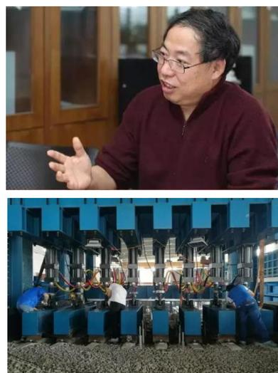
全国各地的高铁运行。在浙大建工学院的实验大厅，记者看到了这套由陈云敏团队自主研发的高速铁路全比尺动力试验创新装置。映入眼帘的是高达数米的路基，路基之上是轨枕、铁轨，铁轨之上，不是列车，而是 8 个动力激振器。实际上，铁轨也是分为 8 截互不相连的。“这些激振器每秒最快能起降 30 次，像‘弹钢琴’一样快速地此起彼伏，把车轮驶过铁轨的连续过程模拟出来，最高能够模拟轮轴荷载达 20 吨的列车以 360 公里的时速驶过铁轨”，该装置获得了国家发明专利 11 项，美国发明专利 2 项。
